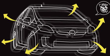
走行中の車体は常に歪みや変形を繰り返している為、サスペンション性能を100%発揮できず、路面の凸凹による突き上げ感や、フラツキを随所感じてしまう。
